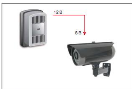
Потеря напряжения на длинной линии
